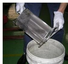
工具を使わず、バルブを開けパチン錠を外すだけで簡単にスラッジ廃棄可能
