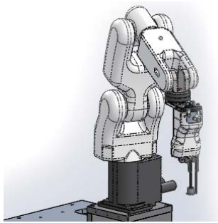
ロボットがバラ積みワークを自動搬送
